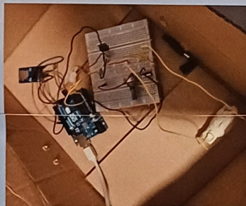
Kuva 2. Kuva mittauslaitteistosta. Laitteistossa käytimme transistoreja, LED:itä, säätövastusta, johtimia, SD-kortinlukijaa sekä Arduinoa.
